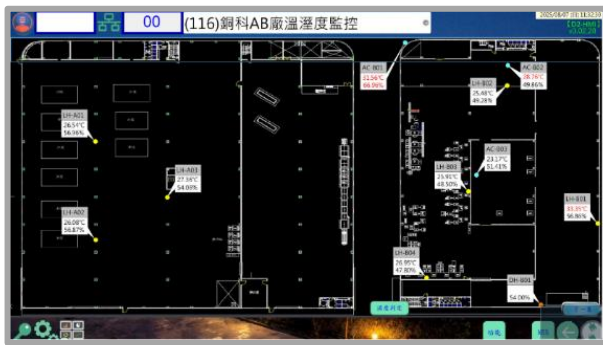
廠內溫溼度管控設備
